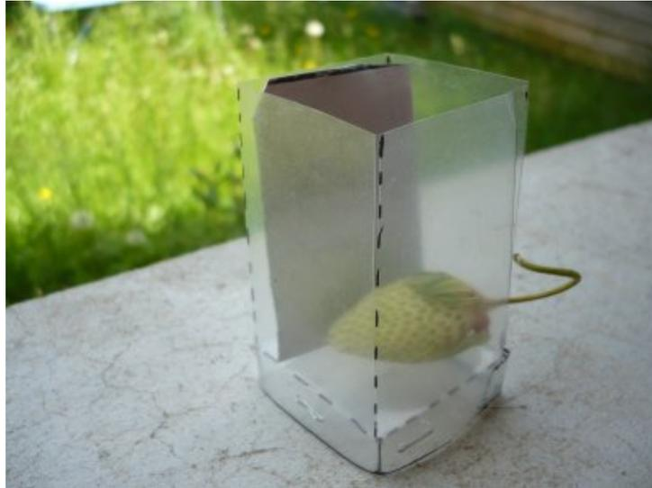
Je vous rappelle que la barquette « drône 3 » a l'avantage de limiter la surface de la « drop zone » mais ne résiste pas à un vent horizontal de plus de 19.46 km/h.
